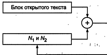
Рис. 4.8. Выработка гаммы шифра в режиме гаммирования с обратной связью
